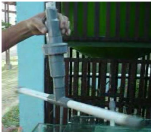
Gambar 10 Sistem Sambungan Prototip Rotary Distributor pada Teknologi Ega Sattira
