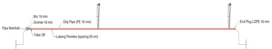
Gambar 11 Potongan Memanjang Desain Blok Irigasi Mini Sprinkler
