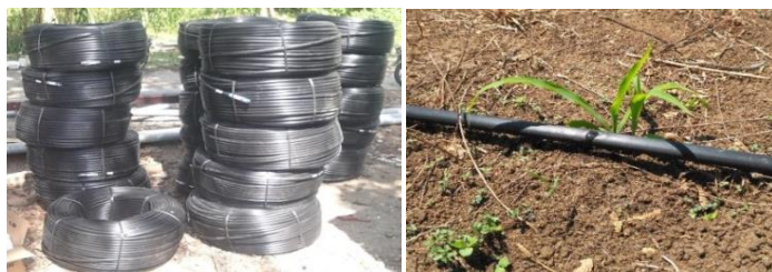
Gambar 7 Pipa Lateral dan Penetes
