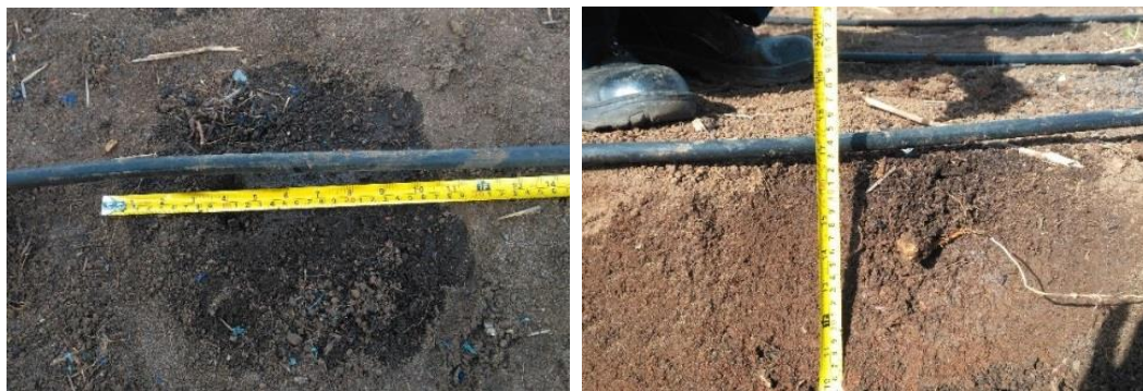
Gambar 12 Pengukuran Luas dan Kedalaman Pembasahan Irigasi Tetes
