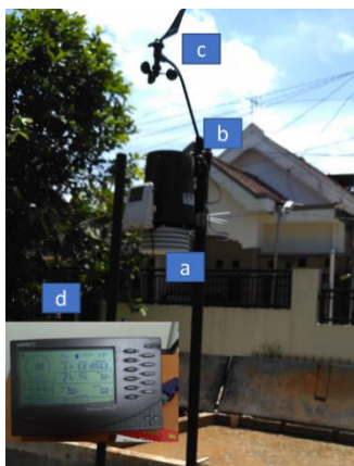
Keterangan: a: sensor suhu dan kelembaban, b: pyranometer, c: anemometer, d: console
